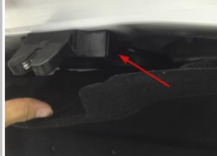
3.17 接门锁信号线：把连接上门锁的接头拔下
