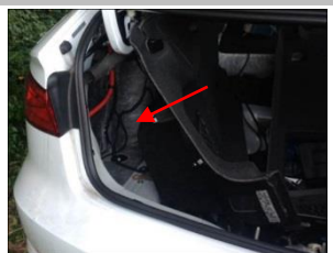
3.3 布正极线拆开原车左尾箱内饰
