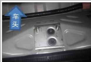
1.6 用两颗内六角沉头螺钉 M6 20 安装垫板组, 根据箭头提示方向装上我司配的垫板, 平行拧紧
