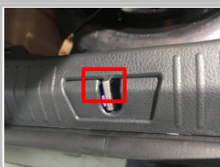
1.10 门锁大后踏盖: 把大后踏盖装还原。(1.上面位置后踏盖与拉耳严重干涉的, 需要割胶; 2.大后踏盖需要毛毡板复原后再安装)
