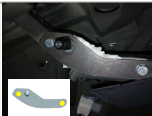
2.6 更换上我司支架(注:我司支架安装方向如下,切勿装反)使用我司配备的 M6 35 螺栓进行安装,螺栓方向也严格按如图方向安装
