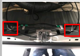
1.8 用扎带固定好拉线, 防止拉线跑到塑胶扣下面, 大后踏盖安装不到位。
