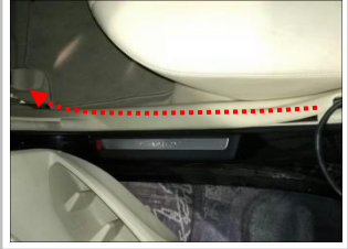
3.6 布正极线：把正极线从 B 柱内引至前门迎宾踏板隐藏（虚线）
