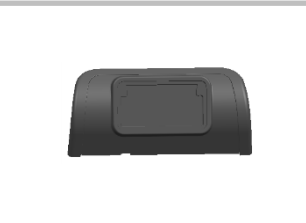
4.6 安装开关按钮：在原车此处装上开关按钮，开关打孔安装
