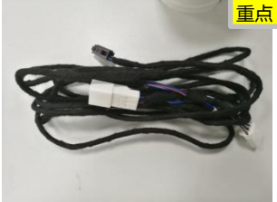
3.18 接门锁信号线：用我们配的转接线连接，再把我司转接线插头（箭头）插进上门锁
