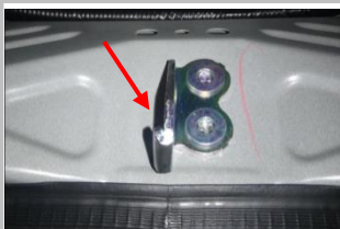
1.5 拆下原车下门锁
