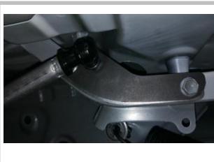
2.8 安装撑杆上固定头 将撑杆另一端固定头卡入支架方孔头,如图所示
