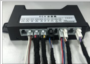
4.1 连接 ECU，把所有各部位线束插头连接好，最后把主线束插头对应安装到 ECU 上，（前面有放大图示意）
