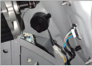
4.4 安装蜂鸣器：与 ECU 接头对接，并把蜂鸣器装在右侧装饰板内空旷处；（箭头）
