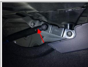
2.4 先将原车气弹簧固定头拆卸(如图),然后将气弹簧向下旋转即可取出气弹簧
