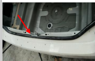
1.4 如图原车后踏盖已拆卸
