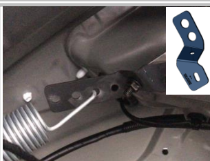
2.12 拉簧支架安装:用 2 个大垫圈 D6, 2 个六角法兰面螺母 M6, 2 个六角法兰面螺栓平行拧紧
