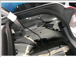
2.13 复原原车拉簧,前面的挂孔还是借用原车,后面需要挂在拉簧支架上,新装车可以挂在靠前的孔,当力量不够可以调到后面的孔。
