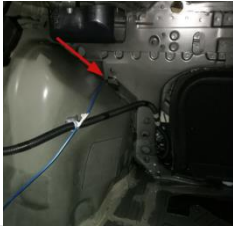
3.4 布正极线 将连接正极的线如图所示，通过尾箱后
