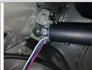
2.10 将下支架限位端孔位对准销钉,如图所示
