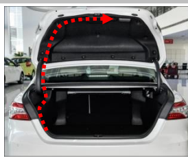
3.2 把 2 扎布线束（接开关、接门锁信号）从左装饰板位沿着尾门胶条把线引到上门锁处
