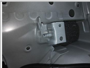
2.7 安装撑杆下固定头:将撑杆圆孔端固定头的圆孔对准如图所示的销钉,然后轻微卡入一部分。(特别注意:不要卡得太深,否则另一端无法安装)
